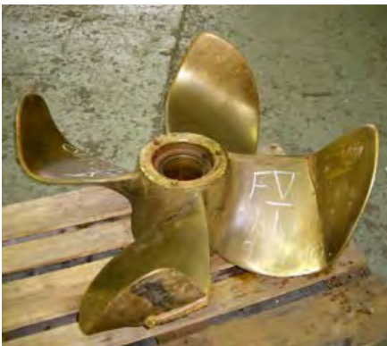
Deformation. So kann eine Schiffsschraube nach der Berührung mit einer Sandbank aussehen.
