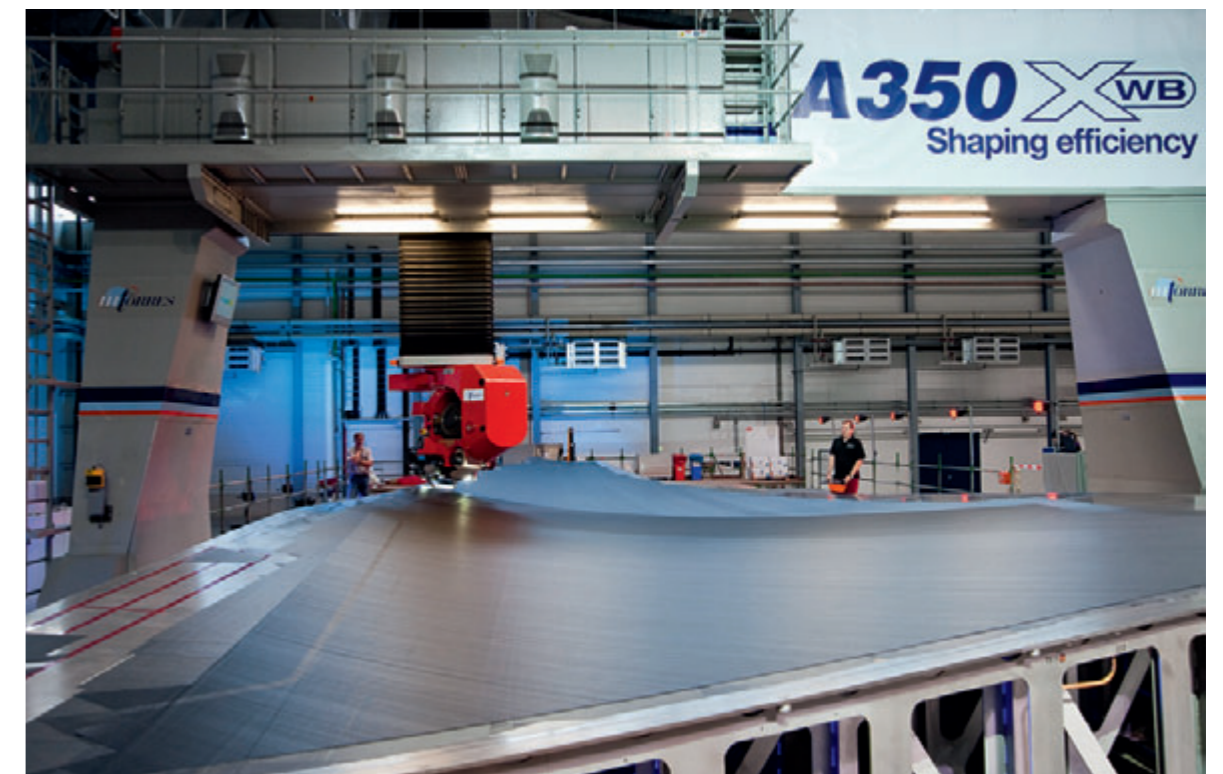
Produktion einer Flügeloberschale für die A350 XWB aus karbonfaserverstärktem Kunststoff (CFK) in Stade. Photo: Airbus
