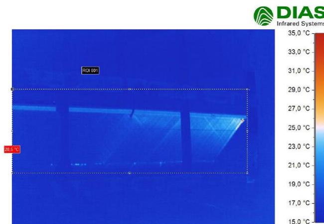
Abb. 18: Infrarotaufnahme des Hochstromtests am Carbon-Gurt
