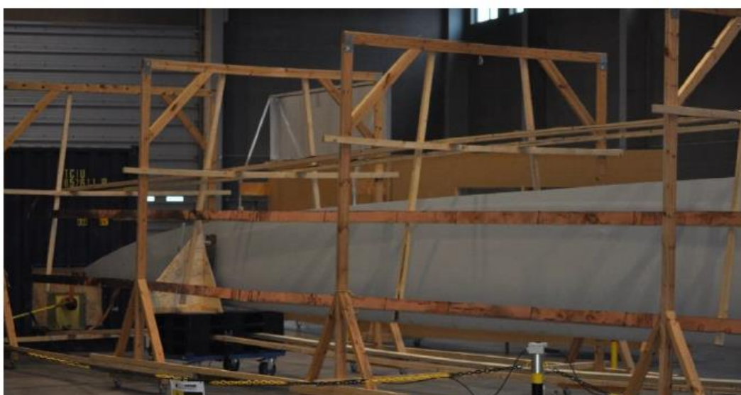
Abb. 17: Hochspannungstest am Gesamtsystem in der Blattspitze
