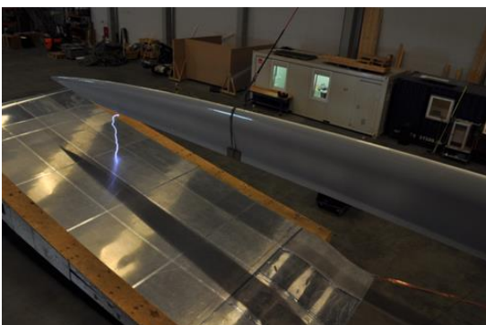
Abb. 16: Entladungen im Hochspannungstest (Labor GLPS in Dänemark)
