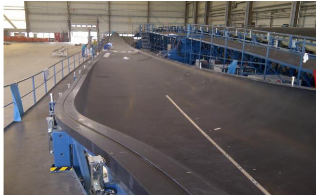
Abb. 9: Fertigstellung der Hauptform
