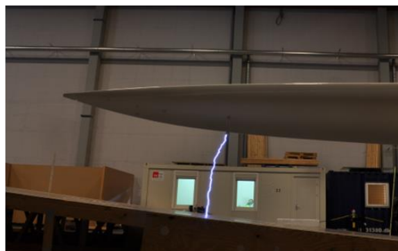
Abb. 16: Entladungen im Hochspannungstest (Labor GLPS in Dänemark)
