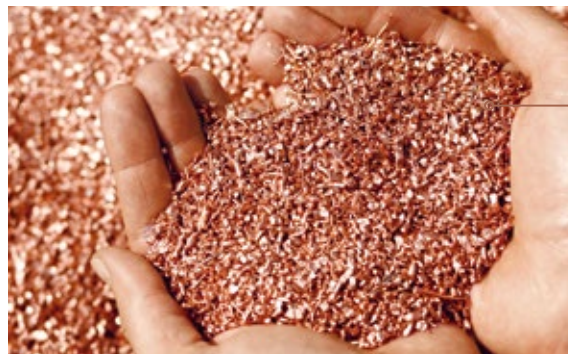
Kupfergranulat, das bei dem Aurubis Tochterunternehmen CABLO aus Altkabeln gewonnen wird.
