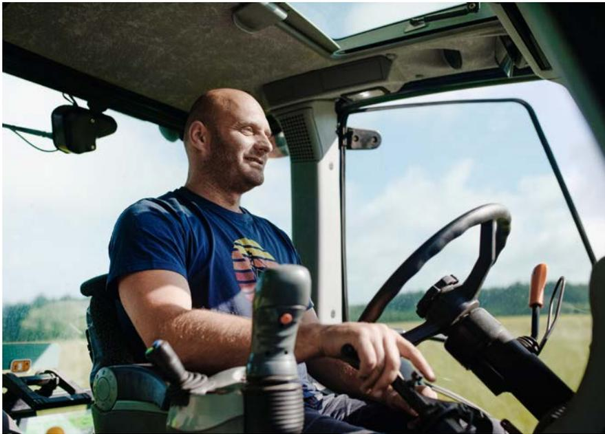
In guten Händen: Das Automatikgetriebe des Deutz-Traktors wurde für Uli Schmölz mit zusätzlichen Hebeln für Gas und Bremse ausgestattet.
