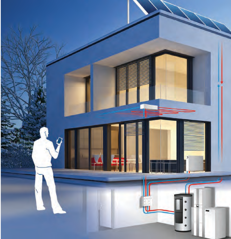
Die Heizung digital im Griff: Internetfähige Ölheizgeräte lassen sich bequem via Smartphone und App fernsteuern und in umfassende Smart-Home-Lösungen integrieren.
