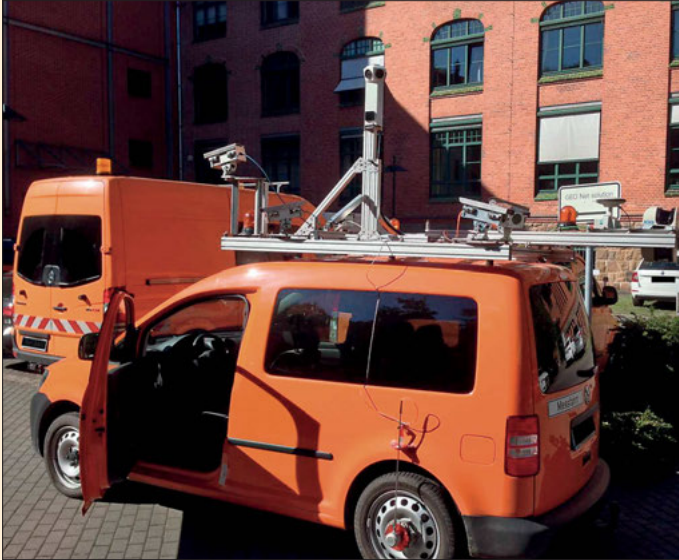
Messfahrzeug zur Straßendokumentation.
