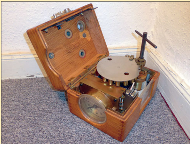
Geöffnete Holzkasten-Brieftaubenuhr ca. 1926 mit mechanischem Uhrwerk und analogem Stempeldruck. Foto: Thorsten Richter
