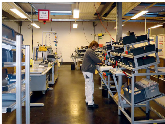
In Montage-Inseln werden alle Schritte, die zum Bau einer Waage notwendig sind, von einem Mitarbeiter geleistet. Fotos: Thorsten Richter
