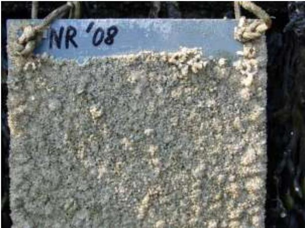
Diese unbehandelte PVC-Referenzplatte war bereits am 24. April 2009 vollständig mit einer neuen Generation von Seepocken (*Balanus crenatus*) bedeckt.
