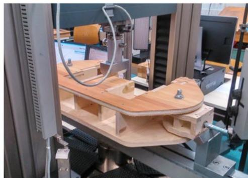
Abbildung 1 und 2: Skizze des Fahrgestells (Grafik: The FlatWorks); Bauteilprüfung (Foto: Marius Cords)
