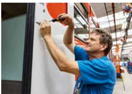
Sehen aus wie neu, sind aber aufgearbeitet und lackiert: die Schwenkschiebetüren an den überholten Fahrzeugen der Baureihe 472.
