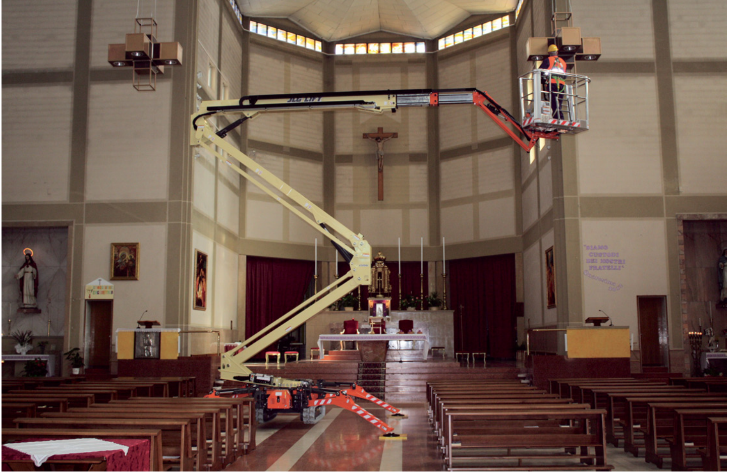
Die kompakte JLG Raupenarbeitsbühne X15J Plus ist klein und leicht, kann aber 230 kg im Korb bewegen. (Foto: JLG Deutschland GmbH)
