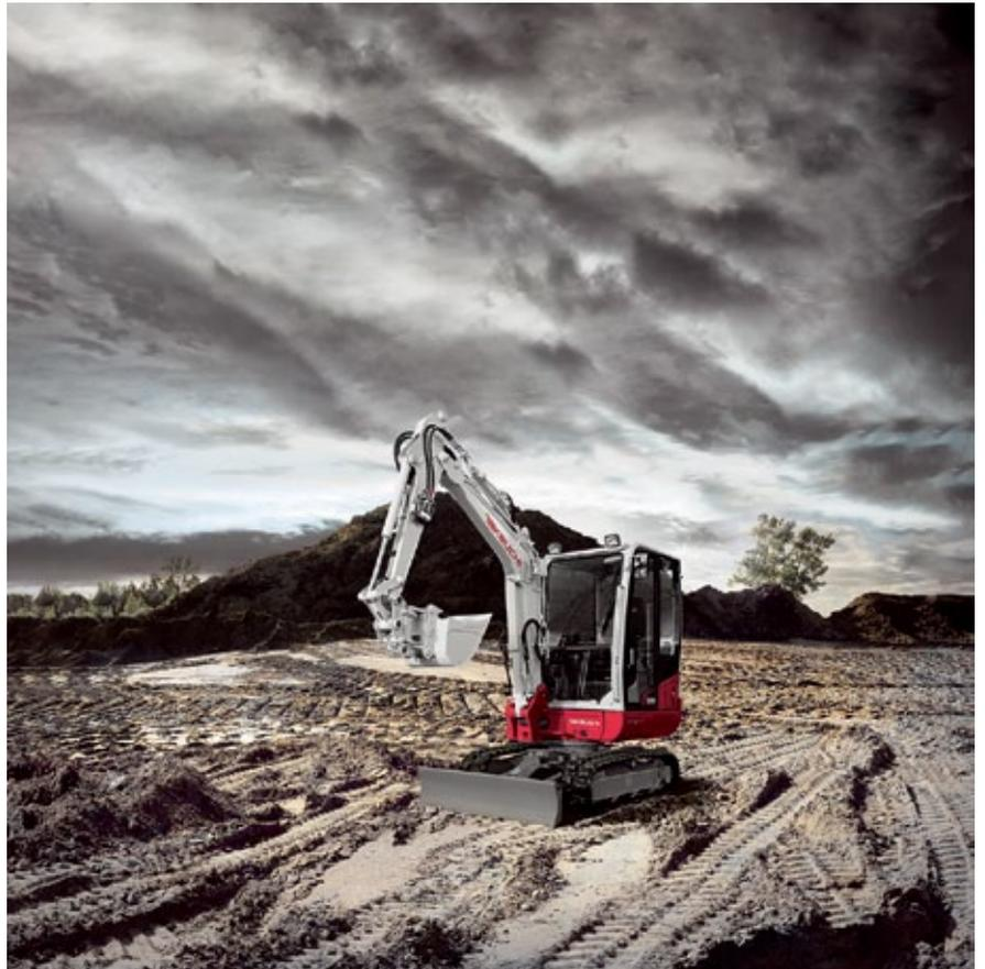
Der kompakte Takeuchi TB 230 mit 3 t Dienstgewicht, einer umfangreichen Serienausstattung und ausgerüstet mit einem 3-Zylinder-Motor mit 17,6 kW/23,9 PS.
