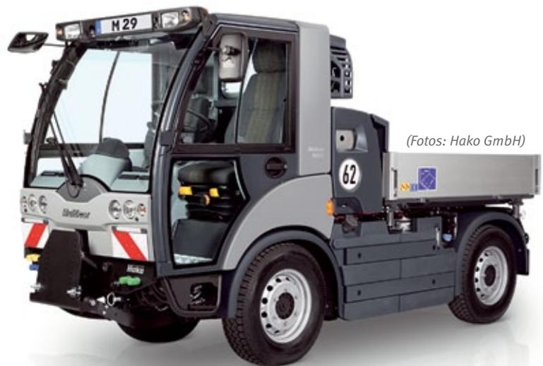
wegen hervorragend eingesetzt werden und bewältigt dabei Nutzlasten von bis zu 3,2 Tonnen. Mit bis zu 62 km/h fährt man mit ihm zügig von einem Ort zum anderen und kann somit auch Autobahnen und Kraftfahrstraßen nutzen.
