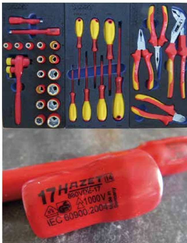
Abbildung 4/13: Isoliertes Werkzeug nach DIN EN 61477 und DIN EN 60900
