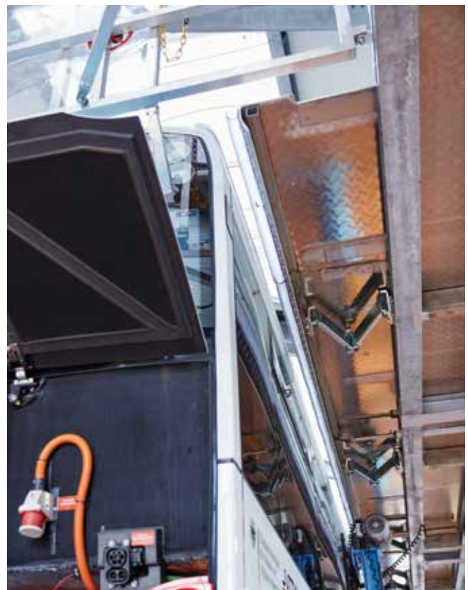
Abbildung 4/5: Der Spalt muss immer kleiner als 0,2 m sein
