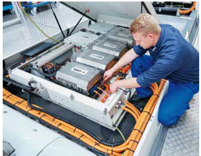
Abbildung 4/9: Feststellen der Spannungsfreiheit auf dem Dacharbeitsstand
