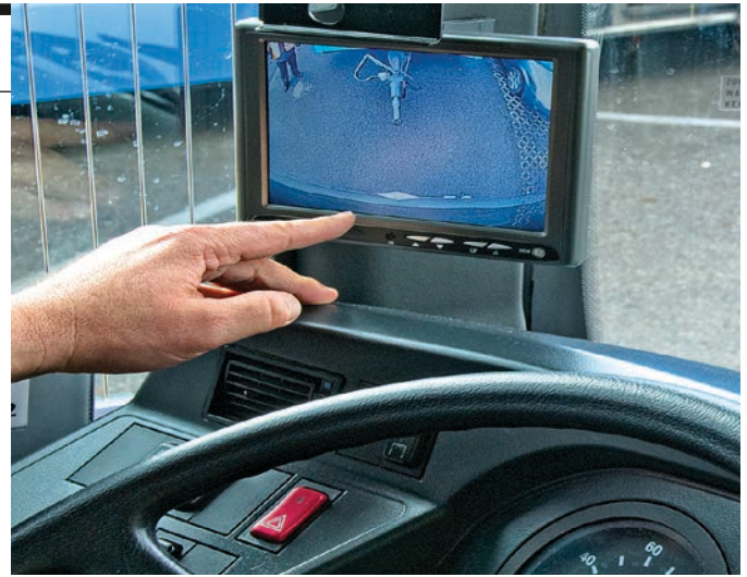
Das Kamerasystem hilft beim Rückwärtsfahren: Sobald die Deichsel auf die weiße Raute trifft, ist der Hänger angekuppelt.
