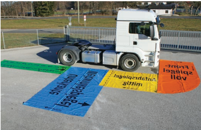
Von der BG Verkehr entwickelte Planen zum Einstellen der Spiegel.
