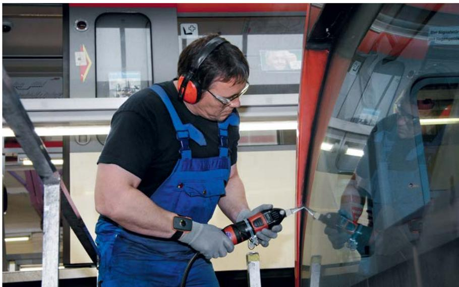
Die Belastungen durch Hand-Arm-Vibrationen sind beim Einsatz oszillierender Messer ohne Schutzmaßnahmen sehr hoch.
