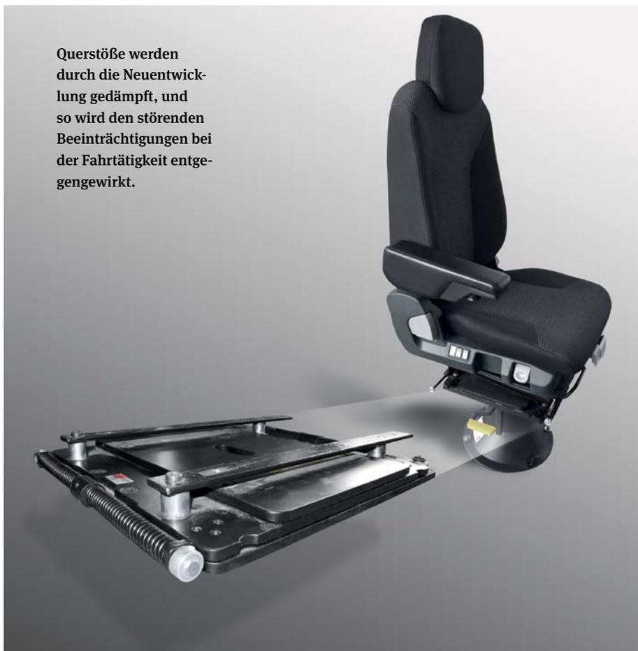
Querstöße werden durch die Neuentwicklung gedämpft, und so wird den störenden Beeinträchtigungen bei der Fahrtätigkeit entgegengewirkt.
