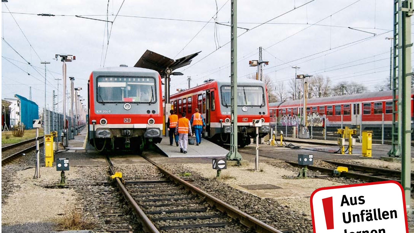
Die Gleissperre verhindert wirksam, dass andere Eisenbahnfahrzeuge auf die zu reinigende Einheit auffahren, und schützt die Beschäftigten.
