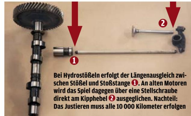
Bei Hydrostößeln erfolgt der Längenausgleich zwischen Stößel und Stoßstange **1**. An alten Motoren wird das Spiel dagegen über eine Stellschraube direkt am Kipphebel **2** ausgeglichen. Nachteil: Das Justieren muss alle 10 000 Kilometer erfolgen
