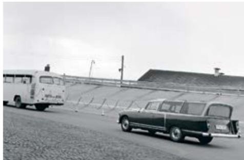
**Rollendes Labor:** Zur Erhebung von Fahrdaten nutzte Mercedes in den 60er- und 70er-Jahren einen umgebauten, mit Messtechnik vollgestopften 300 (oben). Eine Art Nabelschnur stellte die Verbindung zum Testwagen her. Unten: Nachgebauete „Heidestrecke“ als Stoßdämpfer-Marter
