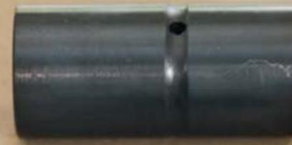
Den Raum zwischen Kolben und Stößel füllt nachfließendes Öl (aus dem Motorkreislauf) auf. Da sich das Öl nicht zusammen- oder aus dem Stößel zurückpressen lässt, gibt der Kolben nicht nach, das Ventilspiel ist ausgeglichen. Über den Verschluss **4** drückt der Kolben auf die Stoßstange und letztlich auf das Ventil.
