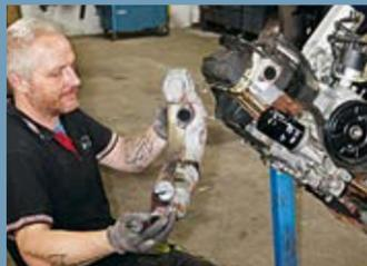
Auspuff und Wärmetauscher (im Bild) werden demontiert. Die Teile sehen schlechter aus, als sie sind
