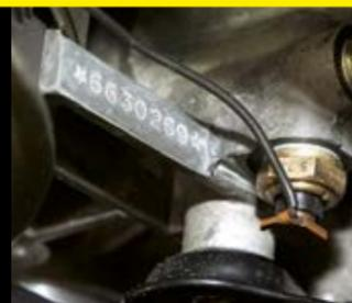
Der Steg, auf dem die Motor-Nummer sitzt, wurde abgeschliffen. Zudem soll die Nummer nicht zum Gehäuse passen
