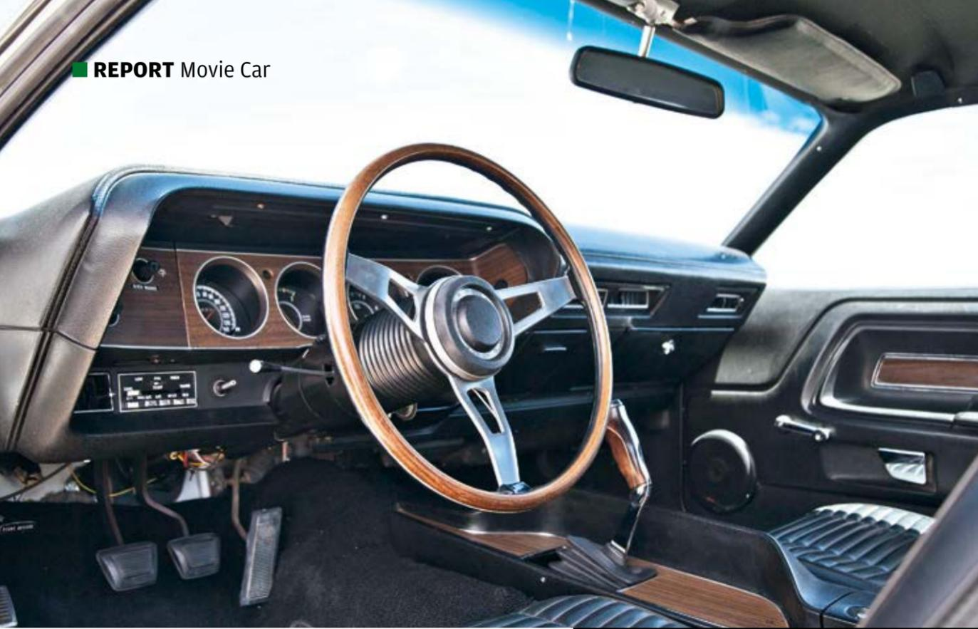
**Kowalskis Cockpit:** Mit Vinyl bespannte Bucket Seats, aufgeklebtes Holz furnier, runde „Rallye“-Instrumente mit Drehzahlmesser und Tacho bis 150 Meilen pro Stunde. Mit dem Schalthebel im Stil eines Revolvergriffs lässt sich die Kraft des 7,2-Liter-Big-Blocks portionieren
