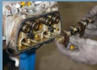
Jetzt geht es an den Ventiltrieb. Der Käfer hat zwei Kipphebelwellen, gehalten von je zwei Bolzen
