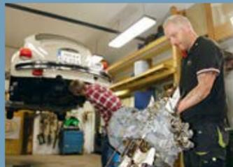
Ein Motorständer ist bei der Demontage Pflicht – so lassen sich alle Verschraubungen erreichen
