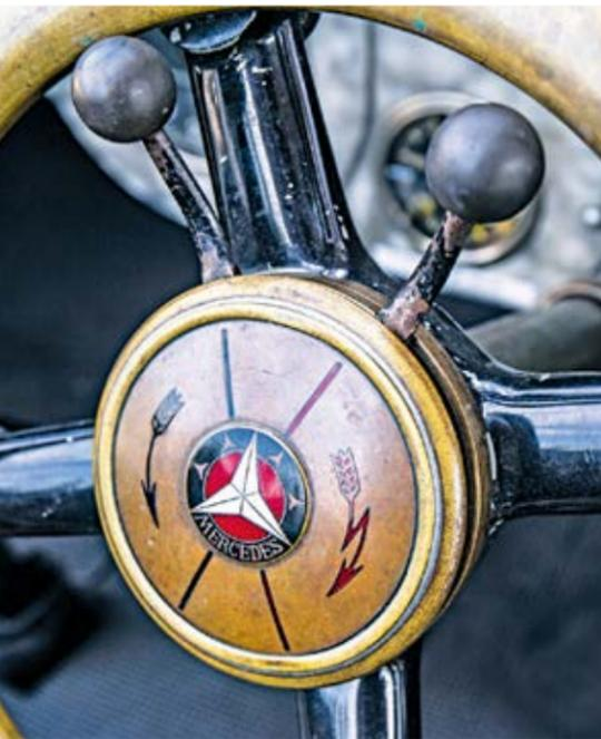
Wer ein Vorkriegsauto pilotiert, ist nicht nur Fahrer, sondern stets auch Maschinist: Mit zwei Handhebeln am Lenkrad (links) werden Standgas und Zündzeitpunkt reguliert. Der SS, hier mit Roadster-Karosserie, hat mit 3,40 Metern einen riesigen Radstand. Um ihn handlicher zu machen, brachte Mercedes 1928 den um 45 Zentimeter gekürzten SSK
