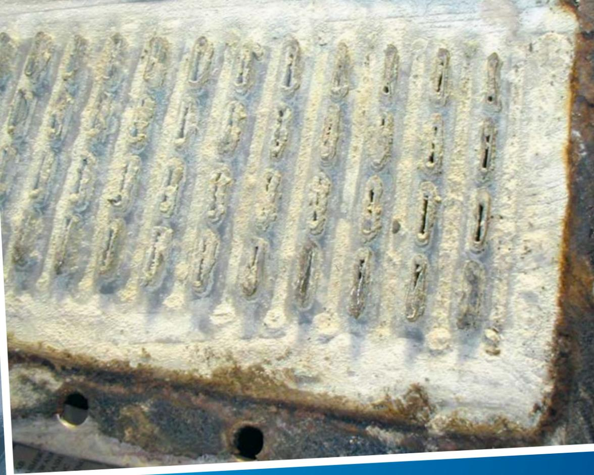
Typische Schäden, die nur ein gut gewartetes Kühlsystem dauerhaft verhindert: Rost (oben) und kalkartige Ablagerungen (rechts) entstehen bei zu stark gealtertem Kühlerschutzmittel. Die Gefahr: Motorschaden!
