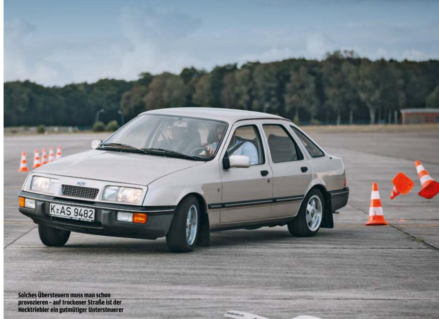
Solches Übersteuern muss man schon provozieren – auf trockener Straße ist der Hecktriebler ein gutmütiger Untersteuerer
