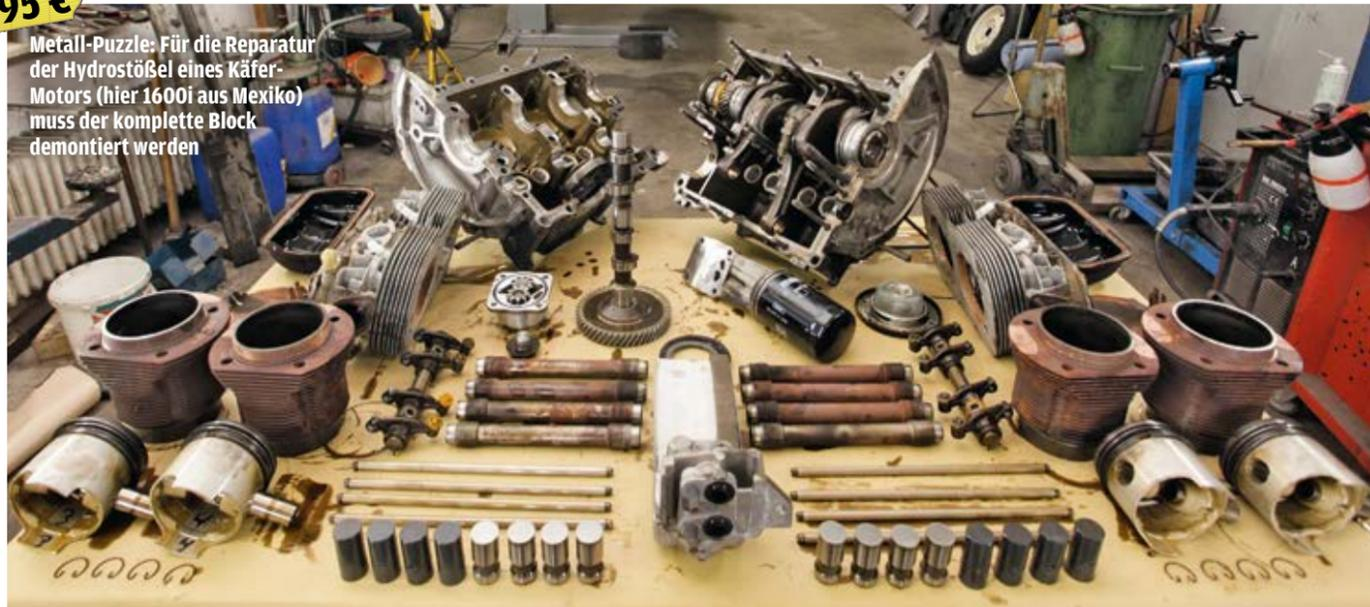
halbe Stunde, bis das „Tickern“ leiser wurde. Zuletzt verschwand der Fehler überhaupt nicht mehr. Selbst Additive – das sind Ölzusätze, die den Hydrostößeln auf die Sprünge helfen – sowie mehrere Ölwechsel brachten keine Besserung. Also: raus damit!
