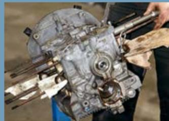
Hier gut zu sehen: die Fuge, die durch Block und Ölpumpengehäuse verläuft
