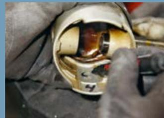
Die einzelnen Zylinder abziehen und die Kolben ausbauen. Wichtig: den Zylindern entsprechend markieren
