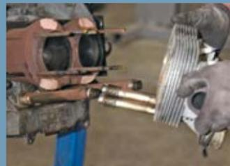
Nun lassen sich die beiden Zylinderköpfe lösen und von den Zylindern abheben
