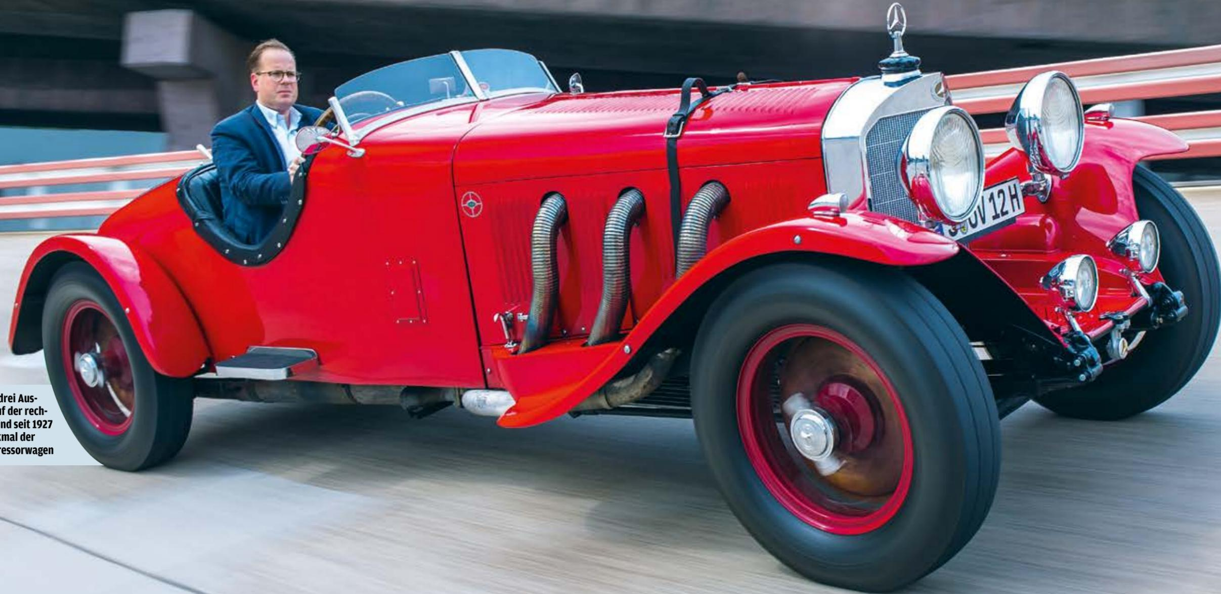
**Volles Rohr:** Die drei Auspuffschlangen auf der rechten Motorseite sind seit 1927 Erkennungsmerkmal der Mercedes-Kompressorwagen
