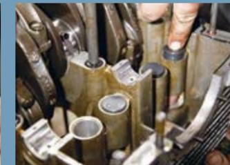
Neue Teile: Nach Einsetzen der Stößel wird der Block wieder zusammengebaut
