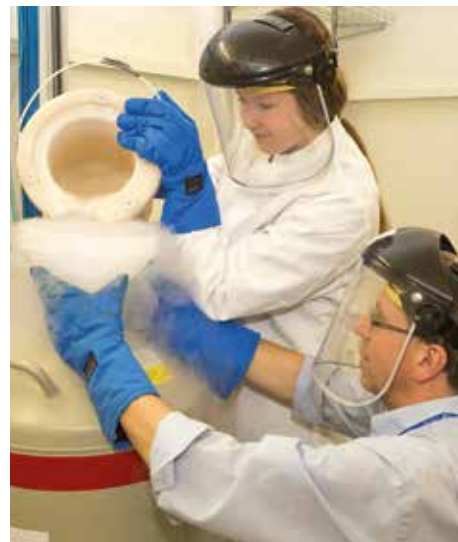
Lena Schmidt und Wolfgang Caliebe füllen -196 Grad Celsius kalten Flüssigstickstoff in einen Detektor.
