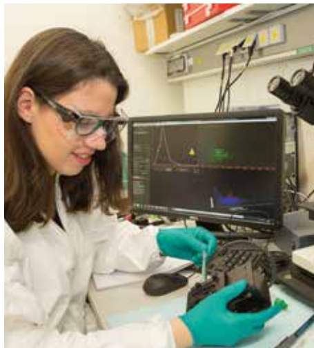
Maren Schumacher befüllt die Messkammer des Nanopartikel-Tracking-Analysators mit Virus-Kristallen, um deren Größe, Größenverteilung und Konzentration zu bestimmen.
