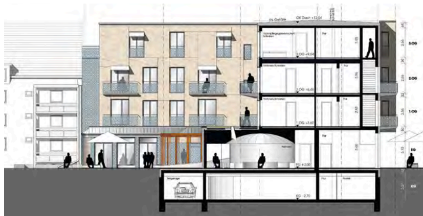
Abb. 53: Tiefgarage unter dem Gebäude (Schnitt)
