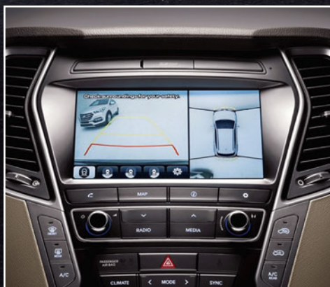
Rundumsicht-Monitor 3 . Kameras an der Front und am Heck sowie an den Außenspiegeln fangen alles ein, was rund um den Santa Fe passiert.
