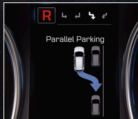
Automatischer Einparkassistent 3 . Das System erkennt Parklücken und steuert den Santa Fe souverän hinein.
