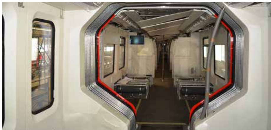
Das Fahrzeug ist durchgängig begebar, klimatisiert und mit Bildschirmen für das moderne Fahrgastinformationssystem ausgestattet. Auf den Displays werden die Stationen in einer Perlenschnur angezeigt, auf langen Streckenabschnitten auch auf den Haltestelleninnenanzeigen.
