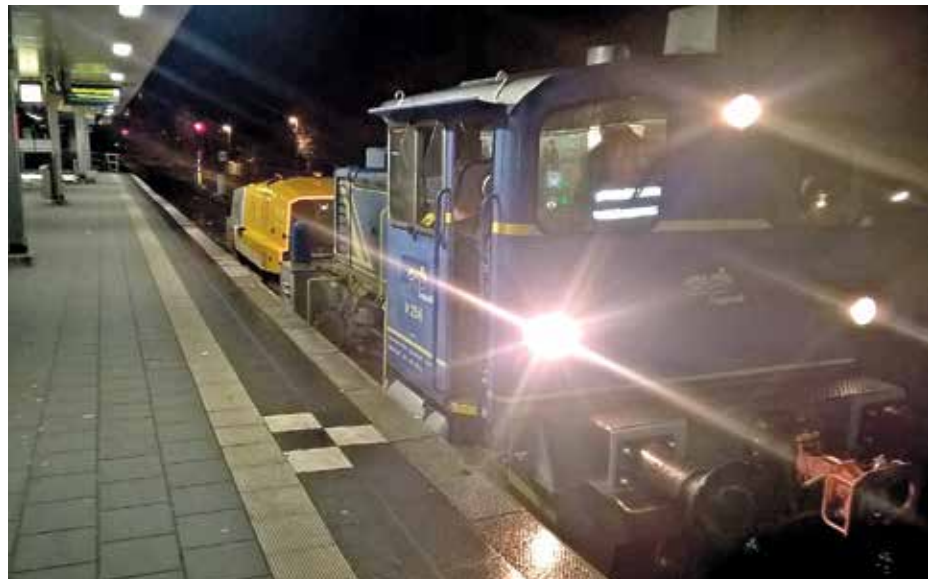
Die HSG-city-Schleifmaschine bei nächtlicher Probefahrt im S-Bahn-Netz.
