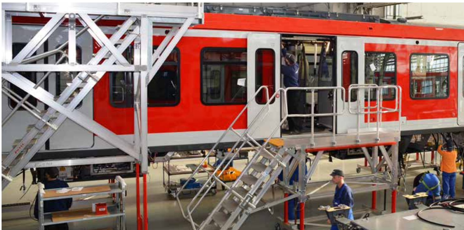
Bei Bombardier Transportation in Hennigsdorf arbeitet ein Team aus 70 Mitarbeitern an der Fertigung des ET 490. In der Endmontagehalle sind erste Wagenschalen in
