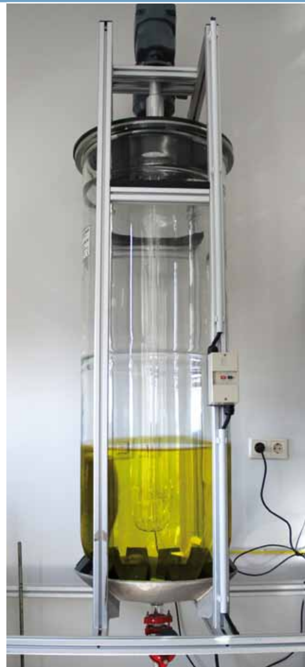
150 L-Glasbehälter plus Glasrührer zum Mischen von Flüssigkeiten
