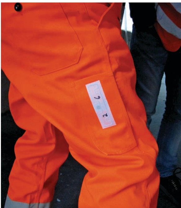
Die BG Verkehr entwickelt einen Transponder, der fest mit der Berufskleidung verbunden ist. So kann der Sender nicht vergessen werden. Sollte ein Mitarbeiter auf das Band geraten, würde die Anlage durch das Signal automatisch gestoppt.
