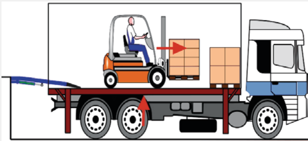
Abb. 1: Der Staplerfahrer ist noch beim Abladen und geht davon aus, dass er den Behälter gleich im Rückwärtsgang verlassen kann.
