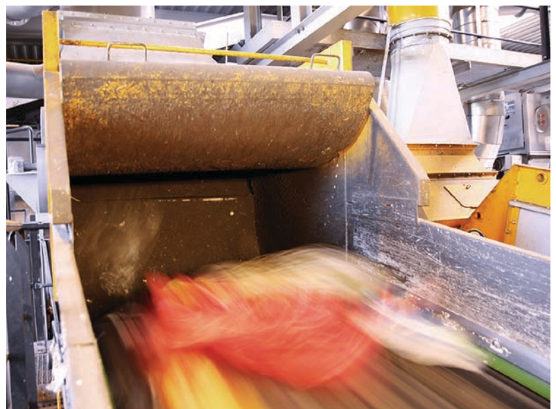
Die BG Verkehr entwickelt einen Transponder, der fest mit der Berufskleidung verbunden ist. So kann der Sender nicht vergessen werden. Sollte ein Mitarbeiter auf das Band geraten, würde die Anlage durch das Signal automatisch gestoppt.
