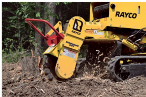
Ein von 89cm auf 127cm beidseitig ausfahrbares Gummikettenfahrwerk garantiert der RG 45 Baumstubbenfräse herausragende Eigenschaften an steilen Hängen sowie auf weichen, schlammigen Untergründen. Um immer genug Ölleistung
