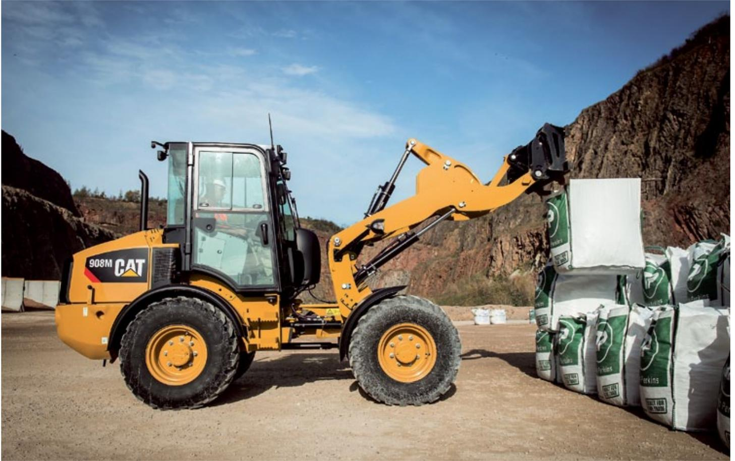
Neu in der Klasse 5 bis 7 Tonnen Einsatzgewicht: Die Cat Radlader 906M, 907M und 908M mit besonders sparsamem Stufe IIIB-Motor. (Foto: Caterpillar)
