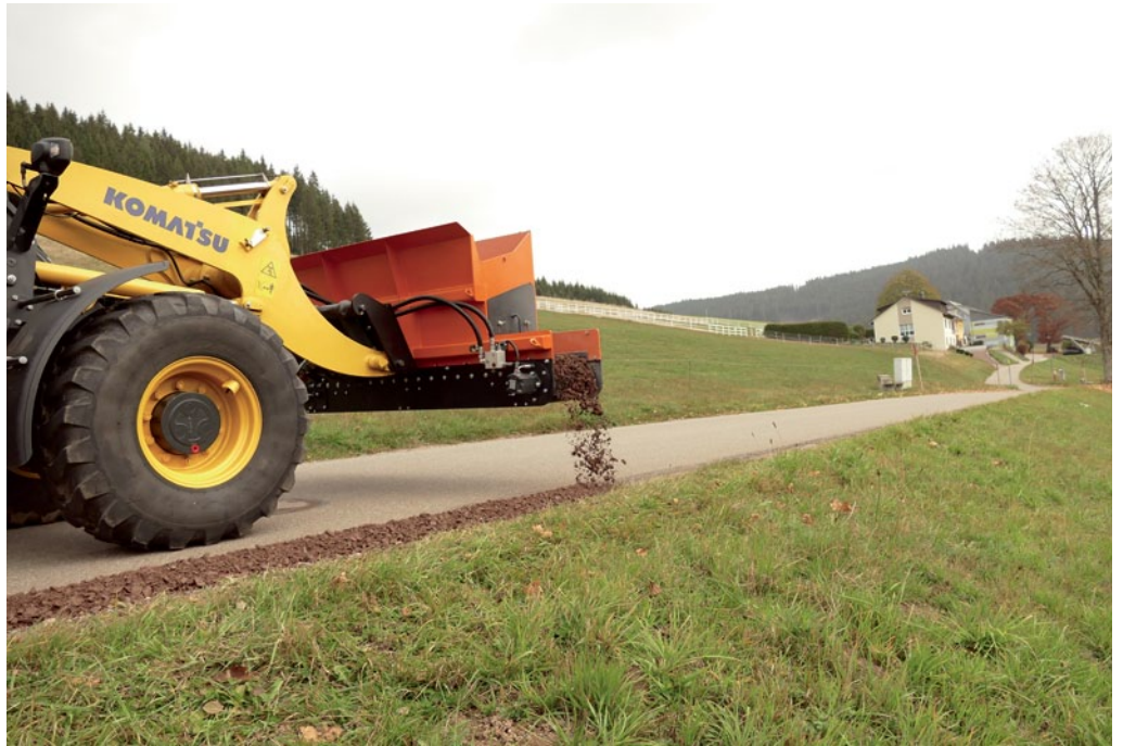
Der Optimas Finliner befüllt in Geradeausfahrt Streukästen oder arbeitet bei der Bankettpflege. Kein Hin- und Herfahren, kein Streuverlust aber präzise steuerbare Befüllung (Foto: Optimas GmbH)
