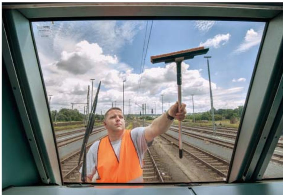
Die Oberkante der Frontscheibe bei der Stirnfensterreinigung an einer Lok dient als Arbeitsgrenze.
