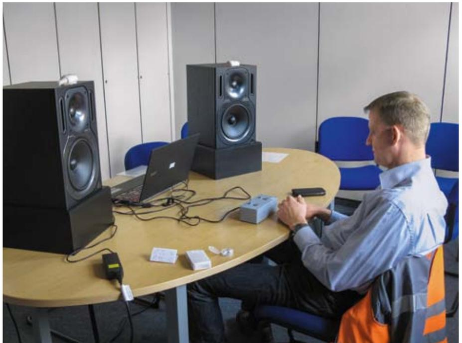
Bei dem neuen Hörprobeverfahren entfällt die Lärmbelastungen für die Umwelt und der Einsatz der Fahrzeuge.
