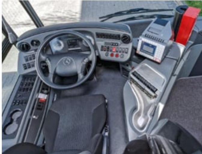
Dieser Fahrerarbeitsplatz entspricht – behutsam weiterentwickelt – der VDV-Schrift 234, und bietet optimale Arbeitsbedingungen für das Fahrpersonal.
