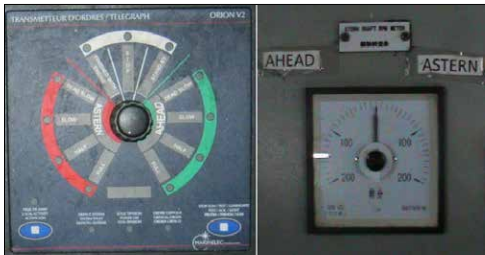
Abbildung 21: Vergleich Maschinentelegraph mit Drehrichtungsanzeige
