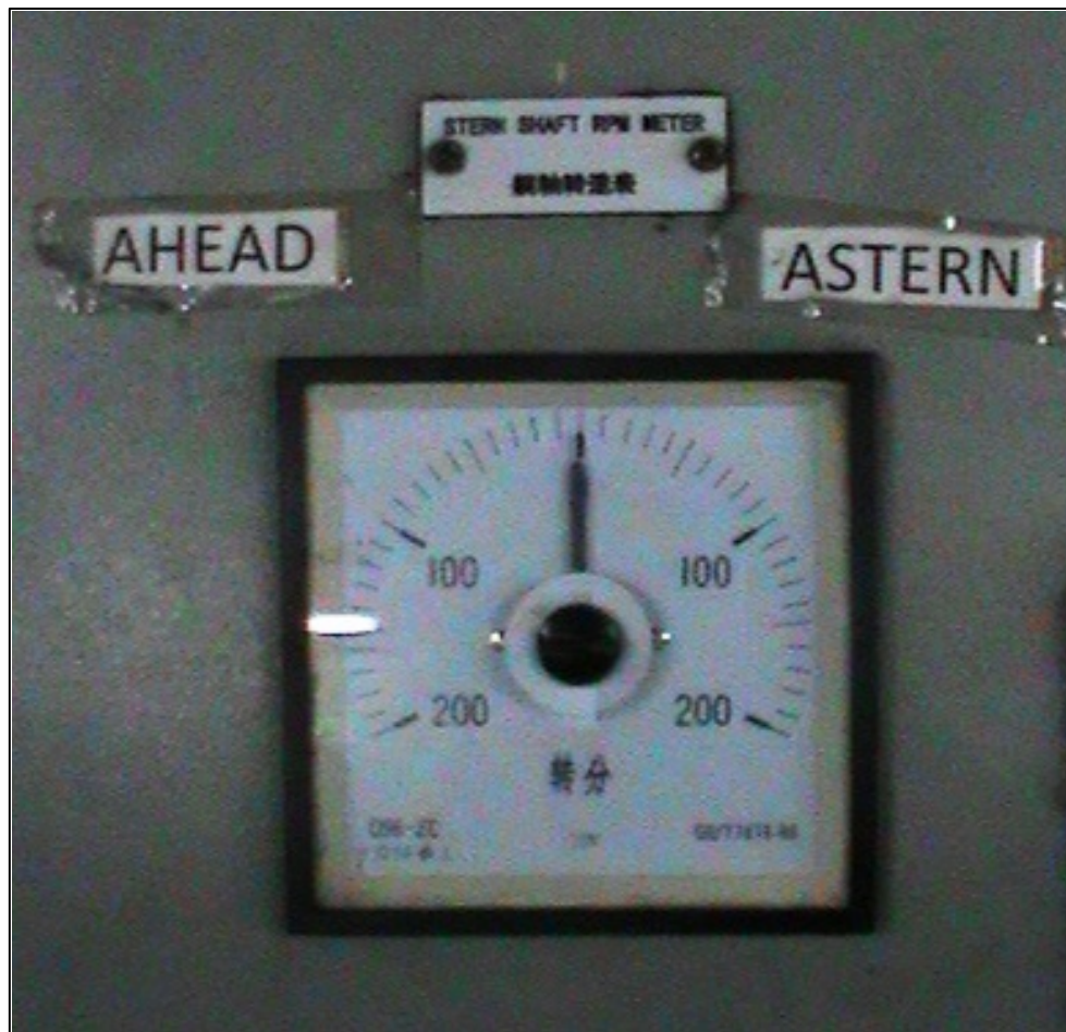
Abbildung 13: Anzeige für Drehzahl und Drehrichtung des Propellers im MKR
