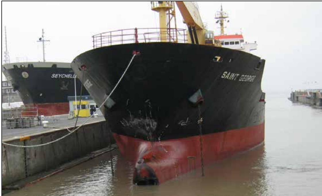
Abbildung 3: Schäden am Vorschiff
