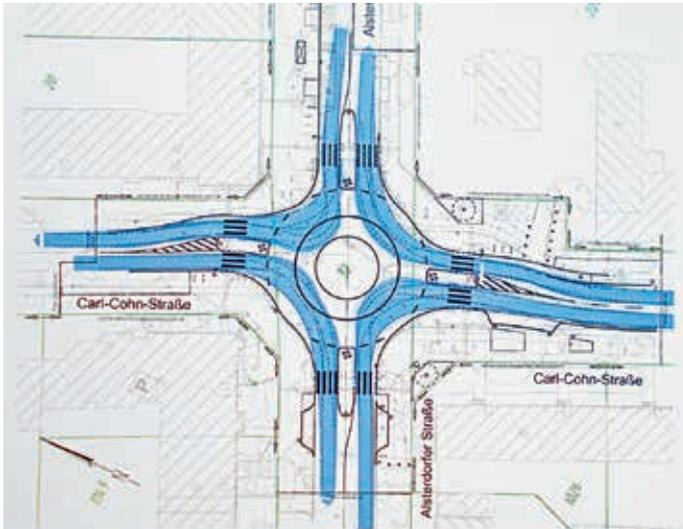
Die Planungen des „Kreisels“ mit der fahrgeometrischen Prüfung für einen Sattelzug (blau)
