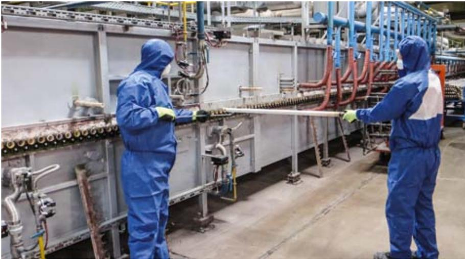
Brennöfen, die mit künstlichen Mineralfasern ausgekleidet sind, sind viel energieeffizienter als Thermoprozessanlagen mit herkömmlichem Mauerwerk. Beim Rollenwechsel mit anschließendem Rollenstopfen können die gefährlichen Fasern freigesetzt werden.
