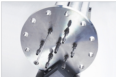
So sehen Tanks für Wasserstoffspeicherung aus, die auf nanostrukturierten Festkörpermateriale basieren. Foto: HZG/Chr. Schmid
