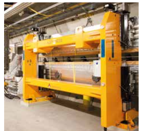
35 solcher Undulatoren werden das superhelle Röntgenlicht in der erste Laserstrecke erzeugen.
