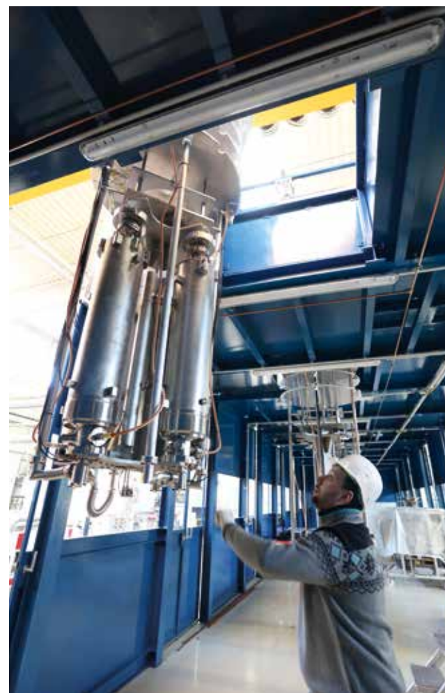
Sechs Einsätze für je vier Resonatoren können in der Präparation bestückt werden. Bilder: Dirk Nölle, DESY
