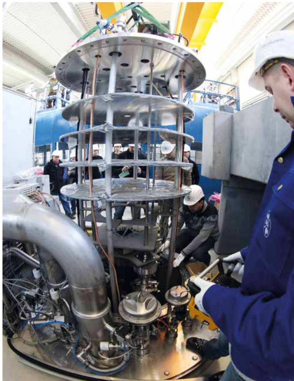
Einer von zwei Kryostaten für vertikale Resonatoren-Tests in der AMTF-Halle
