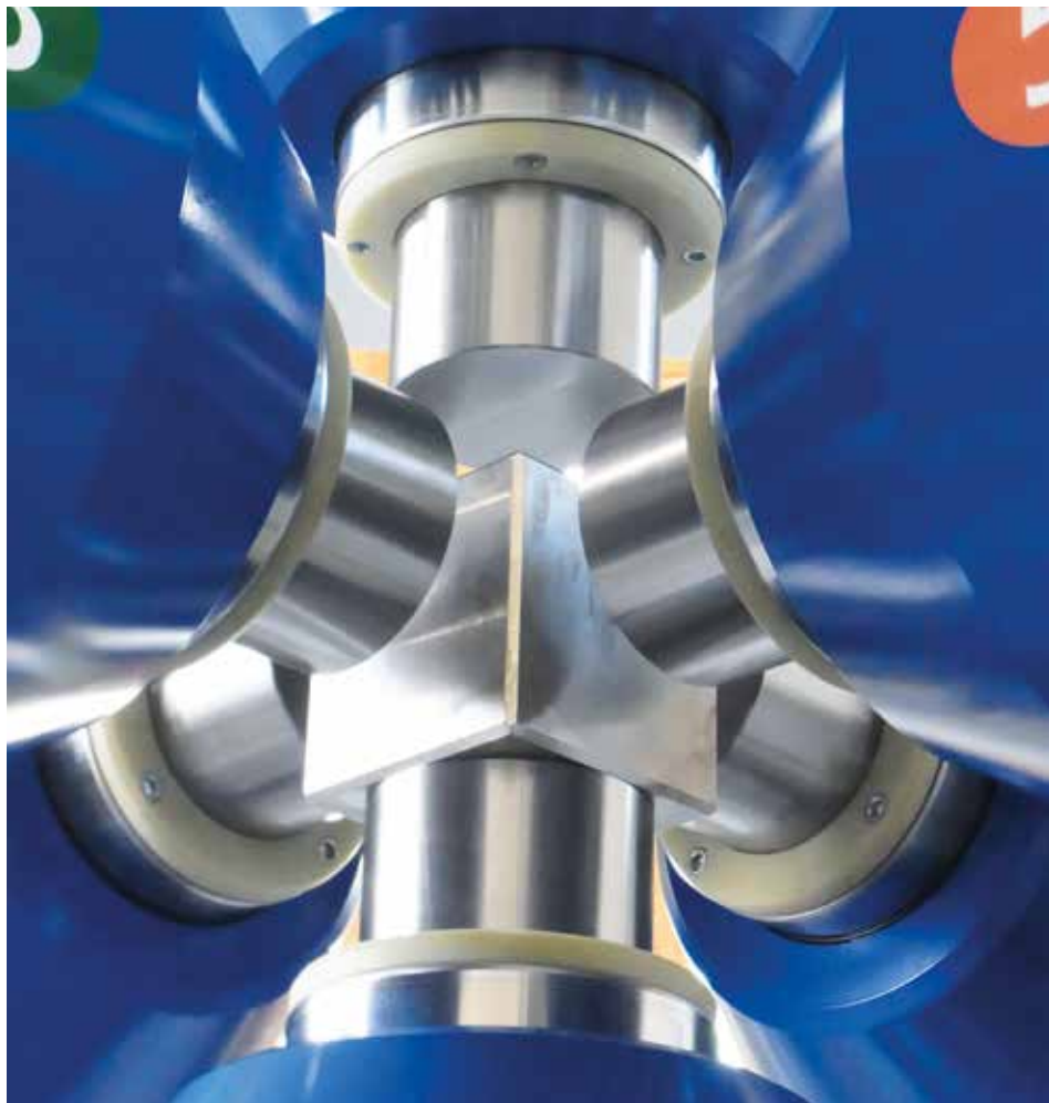
Die sechs Stempel der Presse können in der Probe den 300 000-fachen Atmosphärendruck erzeugen.
