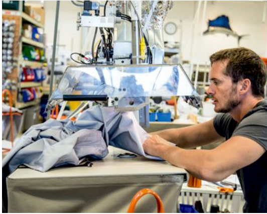
Das Verschweißen der Nähte erfordert viel Geschick und Konzentration, denn Ungenauigkeiten könnten zu Leckagen führen. Alle Wathosen werden daher auf Dichtigkeit geprüft.
