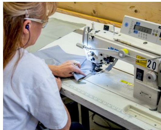
Wegen des Rattens der Maschinen greifen viele Mitarbeiter zu Kopfhörern. Bei den SIMMS-Wathosen sitzen die Beinnähte außen, um ein Aufscheuern beim Laufen zu verhindern.
