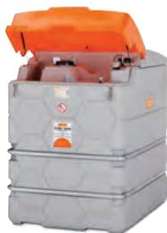
Der neue **CUBE-Heizöltank Outdoor von CEMO** ist eine Einzeltankanlage mit Klappdeckel zum Aufstellen im Freien. Der komplett montierte Tank mit integrierter PE-Auffangwanne und optischer Leckanzeige ist ausgestattet mit einem Befüllanschluss mit TW-Kupplung, Grenzwertgeber, Entlüftungskappe, Füllstandsanzeiger und Entnahmeleitung. Das Tanksystem mit allgemeiner bauaufsichtlicher Zulassung Z-40.21-510 ist in den Größen 1000, 1500 und 2500 Liter verfügbar. **Halle 3A, Stand 215**
