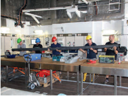
Schwerelos. Im Hangar wird alle 20 bis 25 cm Porwasser aus dem Sediment entnommen.
