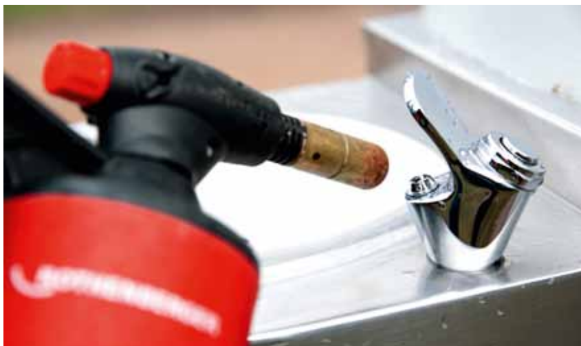
VOR DER ENTNAHME WIRD DER WASSERHAHN ABGEFLAMMT, DAMIT DIE PROBE NICHT DURCH KEIME VERUNREINIGT WIRD.
