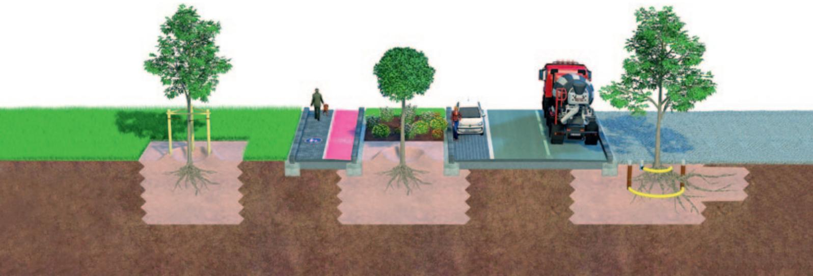
Drei Varianten für jeden Bedarf: HYDRALIT Baumsubstrate von tegra sind für Bauweisen mit und ohne Überbauung sowie speziell für von Schwerlastverkehr beanspruchte Verkehrsflächen erhältlich. (Foto: tegra GmbH)
