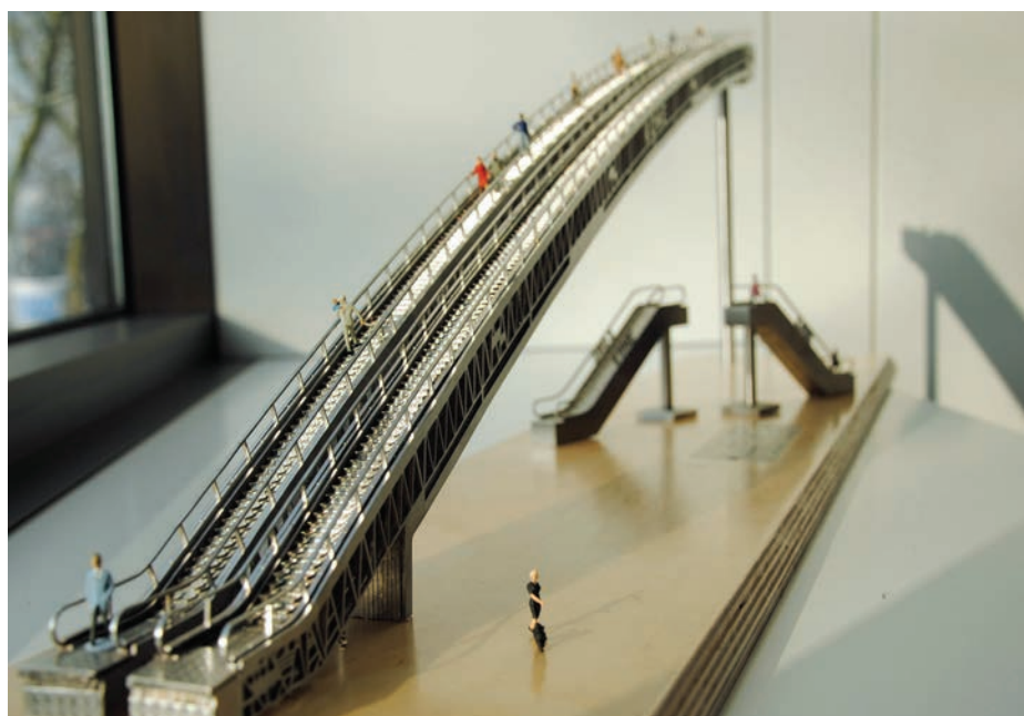
Das Modell (Maßstab 1:87) zeigt die Größe der Bogenrolltreppen im Vergleich zu typischen Kaufhausanlagen.
