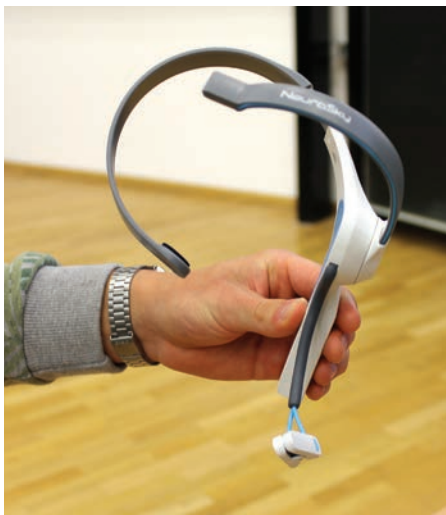
1-Kanal EEG-Headset, das die elektrische Gehirnaktivität im Bereich des linken Präfrontalkortex (Sitz der Aufmerksamkeit) erfasst.
