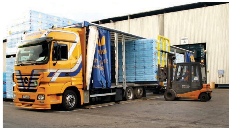
Mit Assistenzsystemen, die die Geschwindigkeit automatisch herabsetzen, wenn das Lastaufnahmemittel angehoben ist, gibt es weniger Unfälle.
