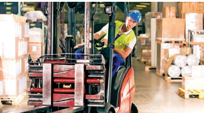
Mit Assistenzsystemen, die die Geschwindigkeit automatisch herabsetzen, wenn das Lastaufnahmemittel angehoben ist, gibt es weniger Unfälle.
