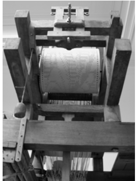
Abb. 7: Die Musterwalze von Vaucansons Seidenwebstuhl, Frankreich, 1745–1748. Auf ihr sind die Abfolgen für das Ziehen der Fäden für ein Blumenmuster perforiert.
