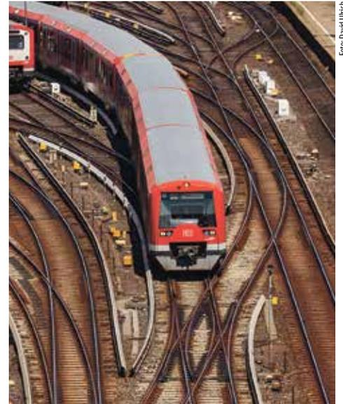
Das in Altona aufgenommene Foto zeigt es: Je mehr Gleise ein Bahnhof besitzt, desto mehr Weichen sind auch nötig, um die Züge in die gewünschte Richtung zu lenken. Die tonnenschweren Konstruktionen halten nicht ewig. Ein kompletter Austausch ist jedoch erst nach Jahrzehnten erforderlich.
