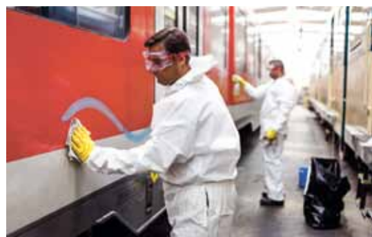
Mit speziellen Graffiti-entfernern geht es Schriftzügen an den Kragen – leider greifen sie langfristig auch den Lack der Wagen an.
