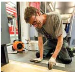
Bei der Nachschau sind Schäden am Boden im Fahrgastraum festgestellt worden, die ausgebessert werden.
