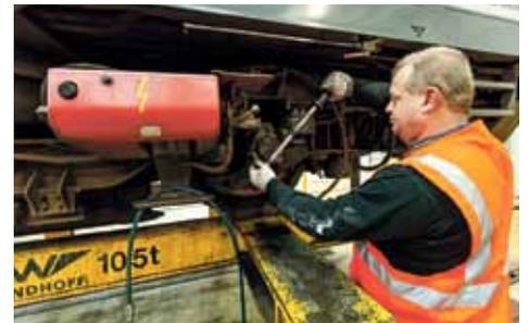
Im Rahmen der großen Inspektion wird ein Gleitschutzgeber mit Defekt ausgetauscht.
