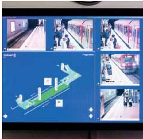
Zur Überwachung werden beide Stellwerke auch mit realen Bildern versorgt.
