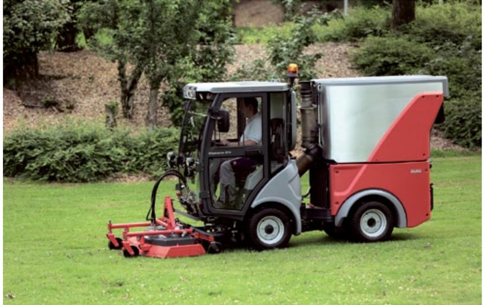
Der Citymaster 600 mit Knicklenkung ist extrem wendig und dank Wechselnutzung ganzjährig einsetzbar. (Foto: Hako GmbH)
