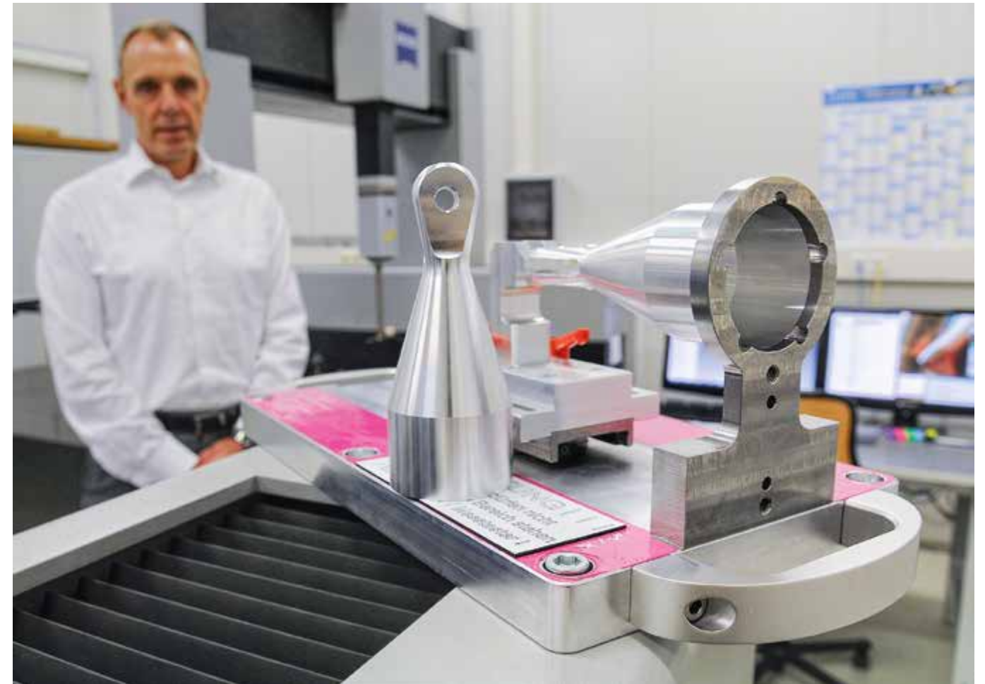
Forschungsobjekt für die Luftfahrt: Dieses Teil will Geschäftsführer Olaf Schreyer künftig gerne mit einem 3-D-Drucker statt an der CNC-Fräsmaschine produzieren.
