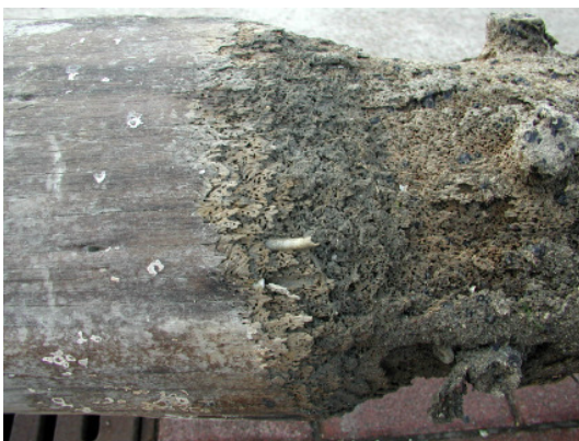
Von Teredo navalis und Limnoria lignorum befallener Duckdalben aus Lärche nach nur 4 Jahren Einsatz im Norderneyer Hafen.
